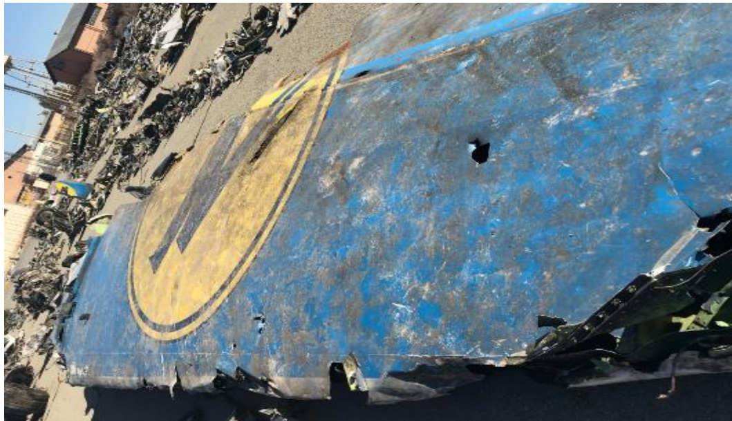
شکل ۲۱- سوراخ و پارگی‌های روی سکان عمودی هواپیما
