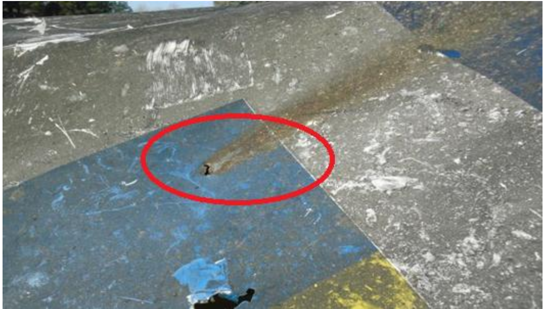
شکل ۱۶- سوراخ بدنه هواپیما با ردی از رنگی متمایز از دود
