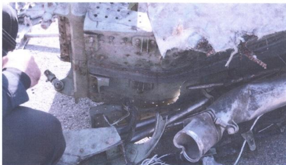
شکل ۳۳- قطعات و بخش هایی از هواپیما که نشانه ای از آلودگی به مواد منفجره نداشتند.
