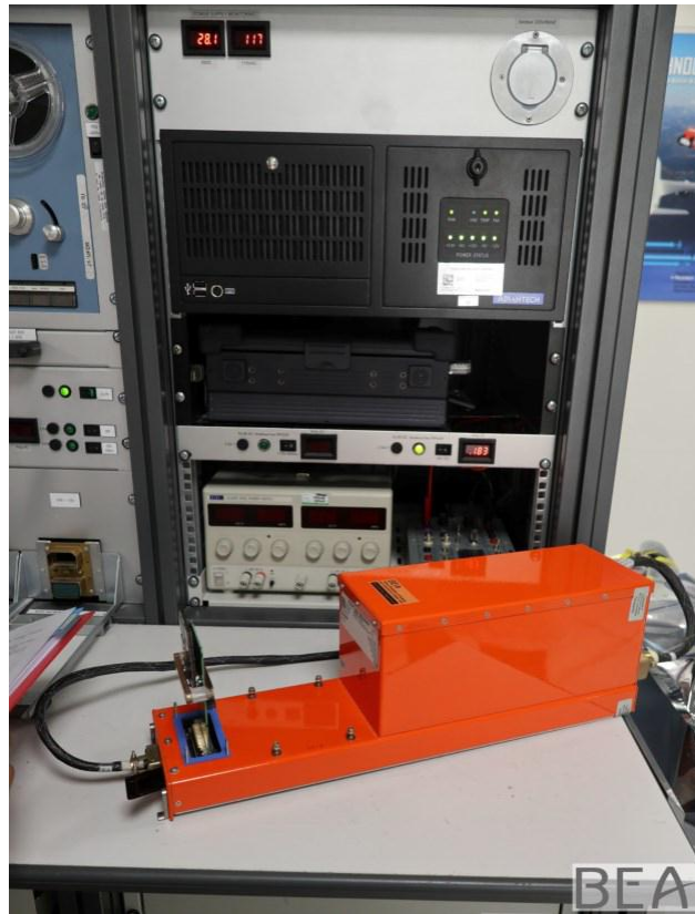
شکل ۳۹- بازخوانی کارت حافظه ضبط کننده داده‌های پروازی در لابراتوار BEA با استفاده از یک بدنه سالم - عکس از BEA
