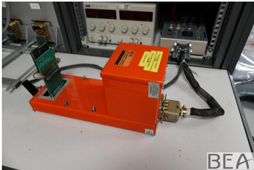
شکل ۳۸- بازخوانی کارت حافظه ضبط کننده صدای کابین در لابراتوار BEA با استفاده از یک بدنه سالم- عکس از BEA
