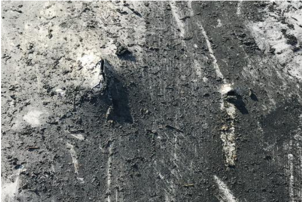
شکل ۲۰- شکستگی به همراه سوراخ رو به بیرون در پوسته سازه نزدیک به کابین هواپیما
