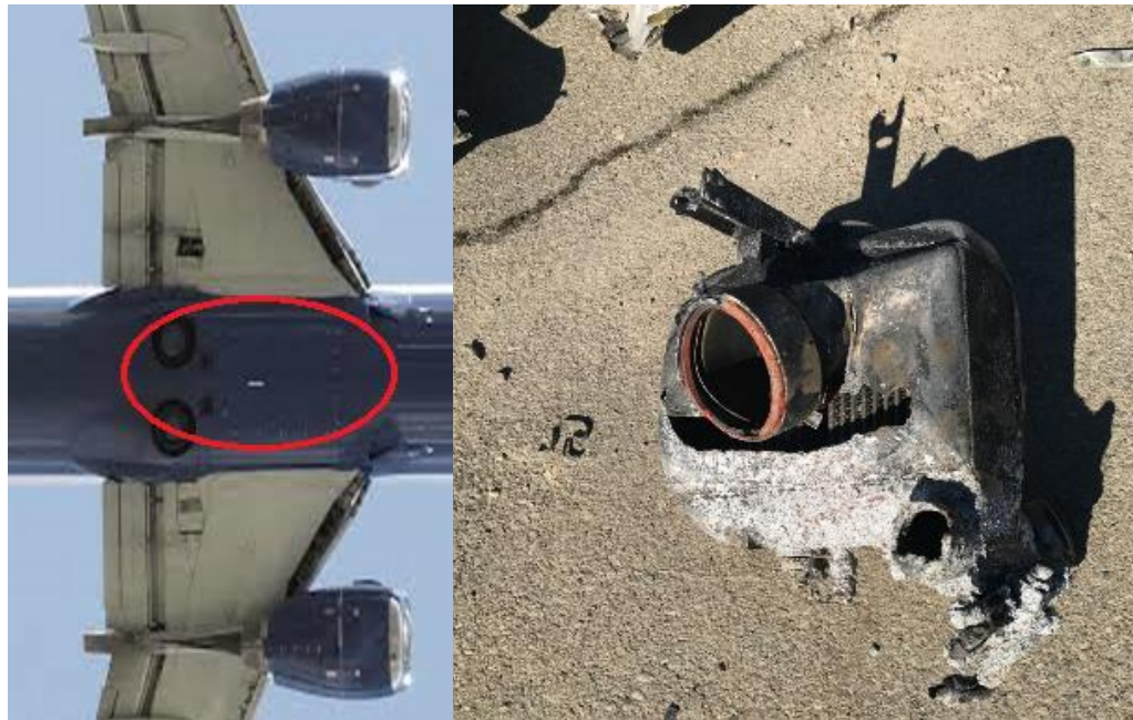
شکل ۲۲- دومین مبدل حرارتی یافته شده در محل سانحه و محل نصب آن بر روی هواپیما
