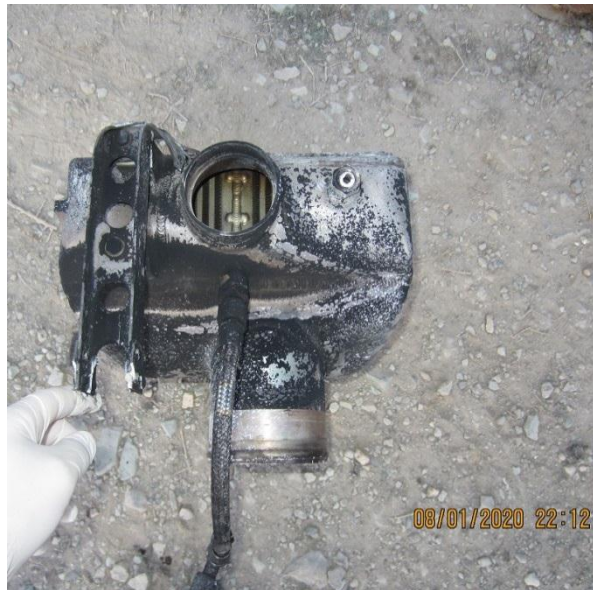
شکل ۱۰- بخشی از سامانه تهویه که قبل از محل برخورد بر روی زمین افتاده بود
