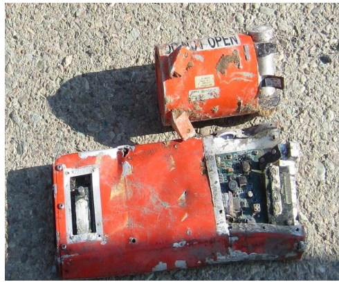
شکل ۳۶- وضعیت ظاهری ضبط کننده صدای کابین پس از سانحه
