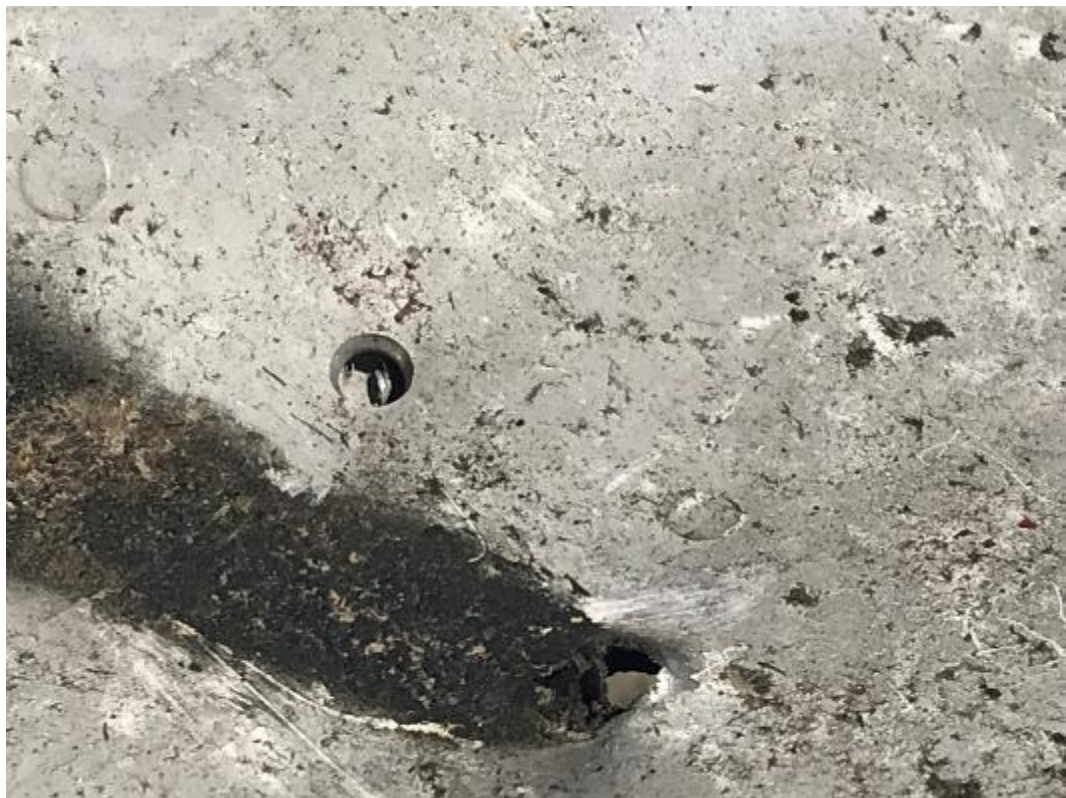
شکل ۱۹- نمای نزدیکتر از سوراخ روی بدنه نزدیک کابین خلبان و آثار سوختگی در ناحیه سوراخ
