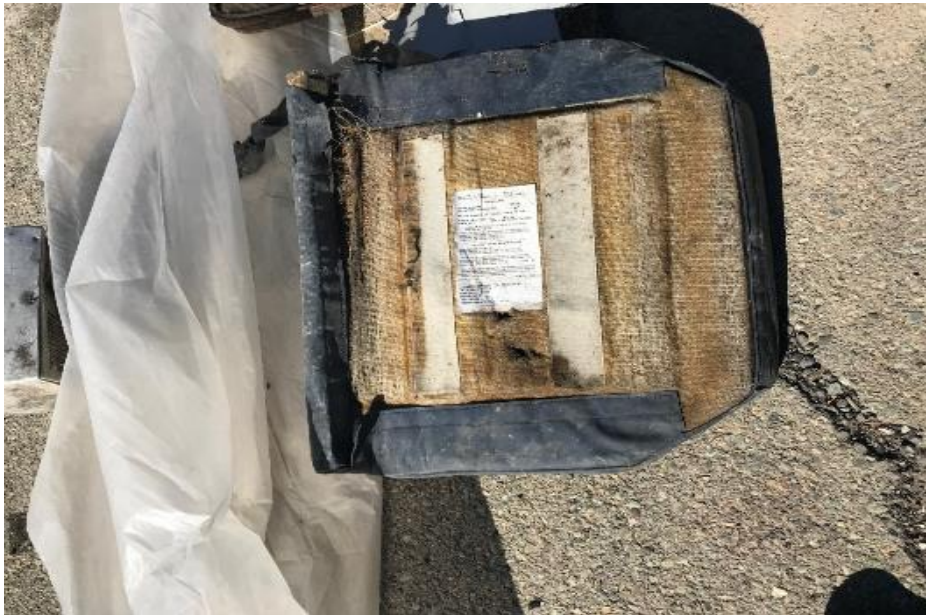
شکل ۲۵- یکی از کفی‌های صندلی مسافر باقیمانده هواپیما با جای سوراخ
