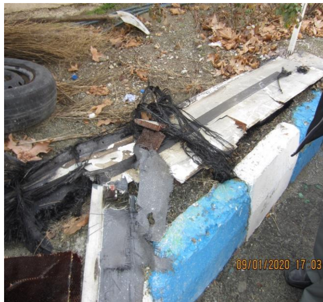
شکل ۹- قسمتی از بال هواپیما که قبل از محل برخورد بر روی زمین افتاده بود
