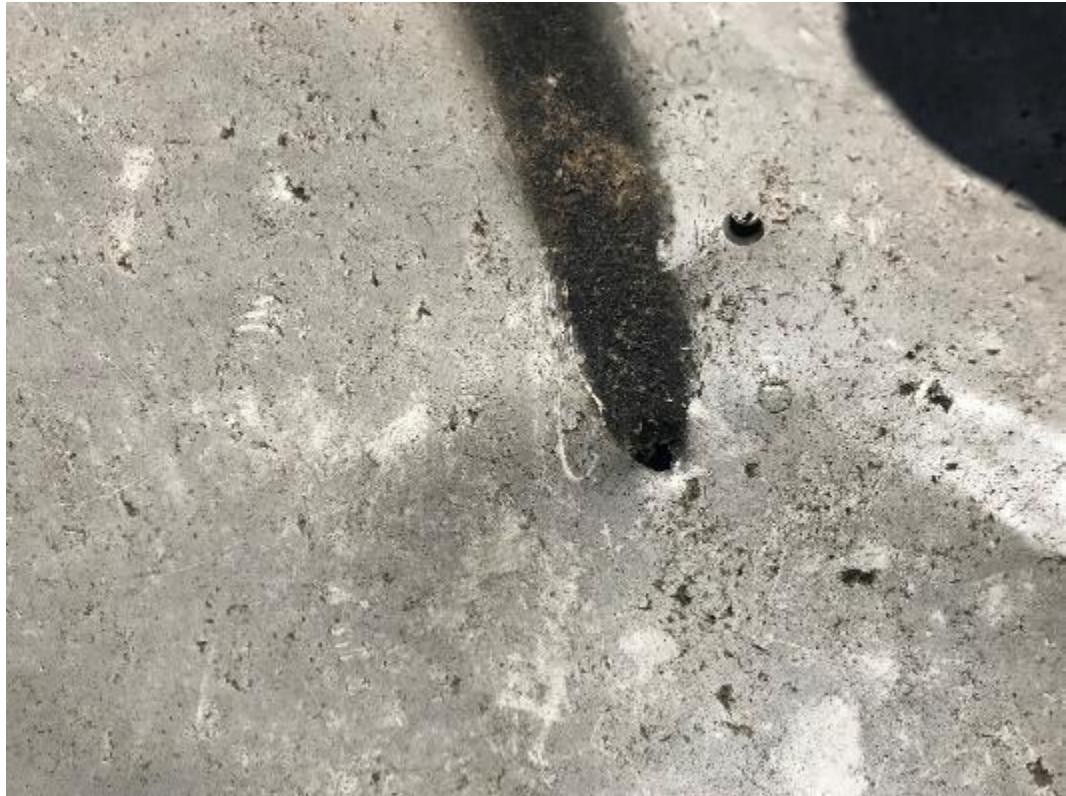
شکل ۱۸- سوراخ روی بدنه نزدیک کابین خلبان هواپیما و دود خروجی
